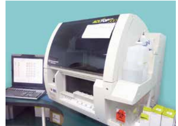
Equipo de coagulación para la realización de pruebas especiales y de rutina.
