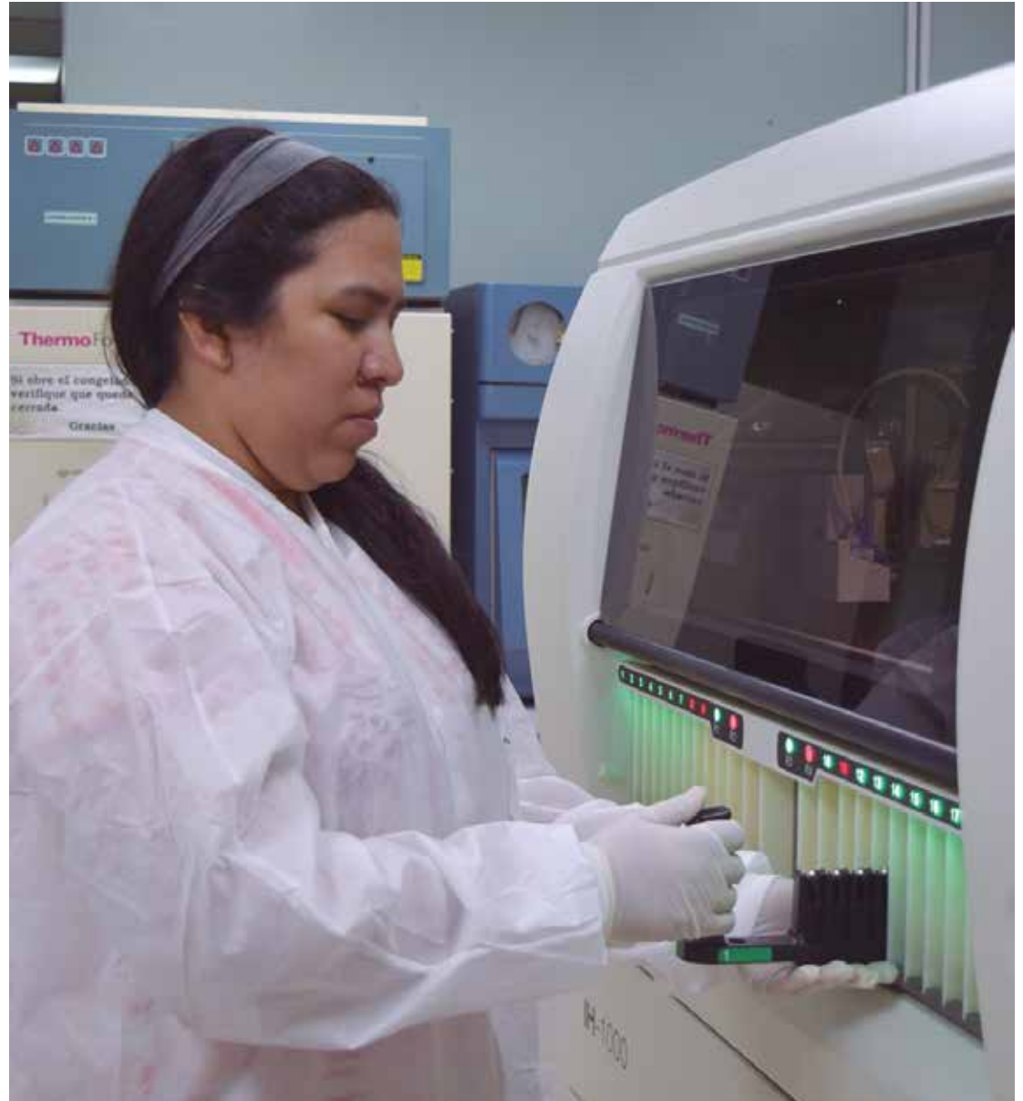
Equipo IH-1000 para prueba inmunohematológica automatizada.
